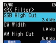
Einstellung der ZF-Filter für den Empfang
