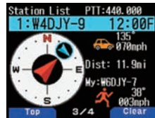
Display-Kompass mit Relativ-Anzeige für die eigene und eine andere Station
