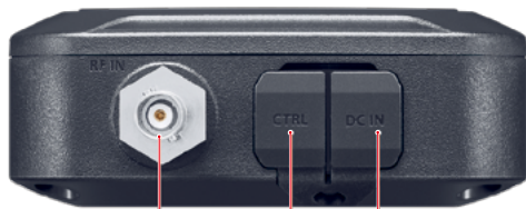
BNC-Buchse (zum IC-705) Buchse für Steuerkabel (zum IC-705) Stromversorgungsanschluss (13,8 V DC)
